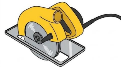
Körfűrész (gyorsvágás, maximum 2400 ford/perc)
