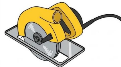
Körfűrész (gyorsvágás, maximum 2400 ford/perc)
